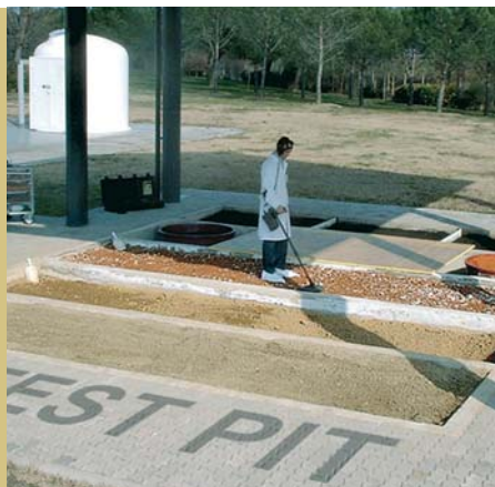
VERIFICHE DI FUNZIONAMENTO SU TERRENI MINERALIZZATI NEL SITO DI PROVA CEIA
