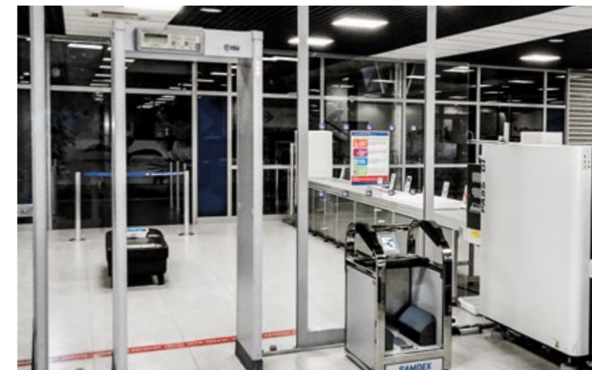
SAMDEX* (Schuh-Scanner Metall- und Sprengstoffdetektor) STAC-zertifiziert, DfT-zugelassen, BPOL-zertifiziert und NCTV-zertifiziert Das erste Gerät mit doppelter Technologie für die gleichzeitige Detektion von metallischen und explosiven Bedrohungen, die in Schuhen versteckt sind, ohne dass die Schuhe ausgezogen werden müssen.
