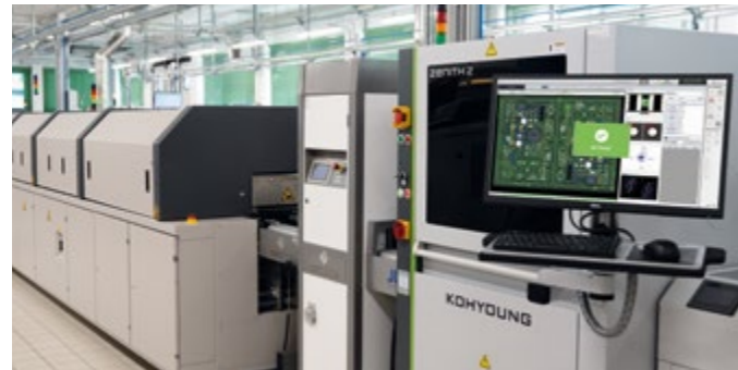
Automatische optische Inline-Inspektion (AOI) von elektronischen Leiterplatten.
