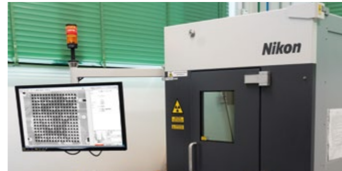
Röntgeninspektion von elektronischen Baugruppen und Komponenten.
