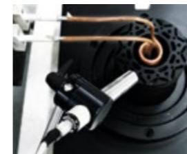
SCHRUMPFMONTAGE DES ROTORS AUF DER WELLE
