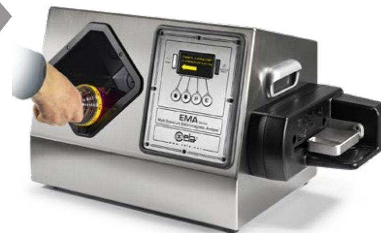
EMA SERIE ECAC Typ B Standard, ECAC Typ A Standard, TSA-qualifiziert Kompaktes Multi-Sensor-Gerät zur Kontrolle von Flaschen und deren Inhalt zwecks Erkennung von brennbaren, entflammaren und explosiven Flüssigkeiten. Wenn der Bediener die Flasche in die Inspektionskammer stellt, beginnt der Messvorgang automatisch.
