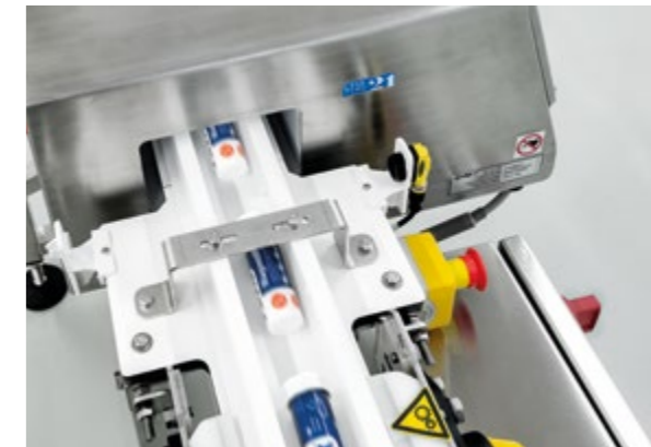
THS/PH210-N-WIP Metalldetektionssystem für Wash-in-Place-Verfahren.
