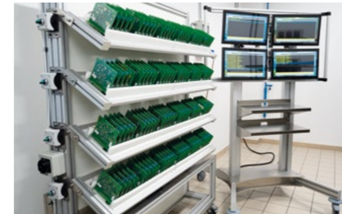
Funktionaler Burn-In von Elektronikplatinen.
