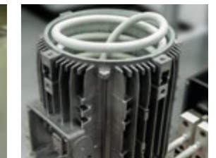
SCHRUMPFMONTAGE DES GEHÄUSES AM STATOR
