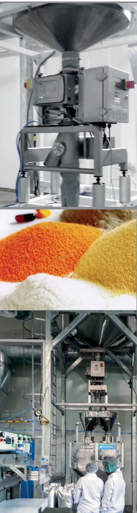
El Sistema integrado THS/FFV21 de CEIA se ha diseñado especialmente para la inspección de productos en polvo y granulados y la eliminación de cualquier metal contaminante, ya sea magnético, no magnético o acero inoxidable.
