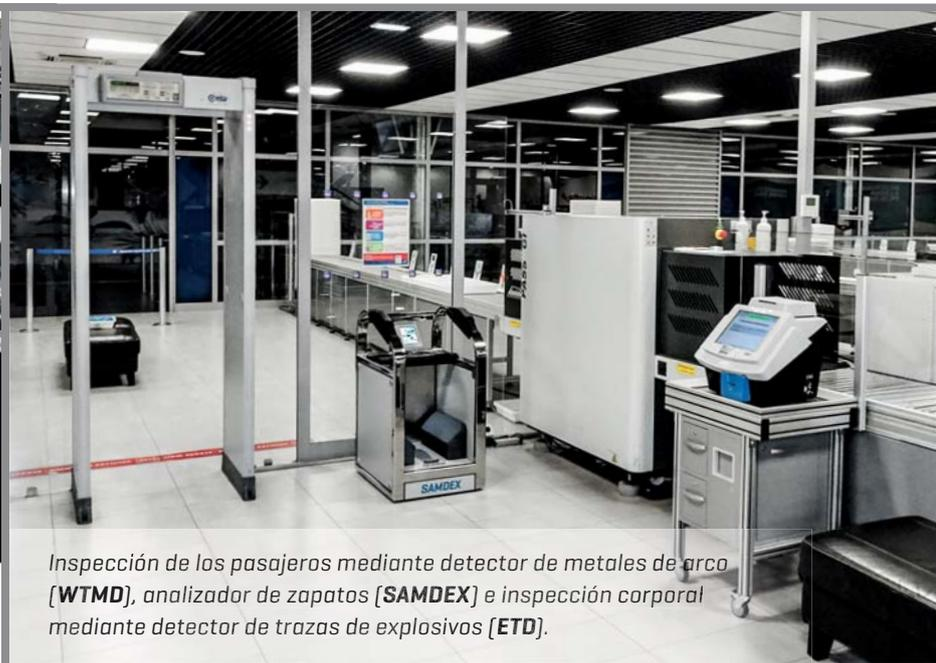
*Inspección de los pasajeros mediante detector de metales de arco (WTMD), analizador de zapatos (SAMDEX) e inspección corporal mediante detector de trazas de explosivos (ETD).*
