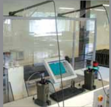
Robot d'étalonnage des détecteurs de métaux MIL-D1 après la phase d'assemblage
