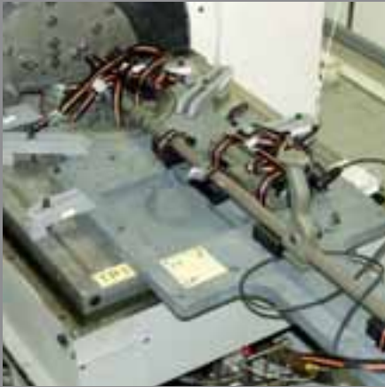
CEIA MIL-D1: essai de choc mécanique
