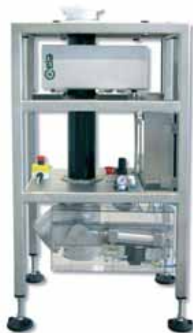
Le système intégré THS/FFV a été spécialement conçu pour l'inspection de produits en poudre et en granulés avec éjection automatique de métaux magnétiques et non magnétiques
