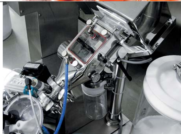
THS/PH21N-WIP : Système de détection de métaux "lavable en place".
