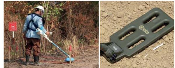
CEIA introduit les modèles multi-capteurs pour les détecteurs de recherche dans les sols, avec GPR, détection de métaux et d'engins explosifs improvisés.
