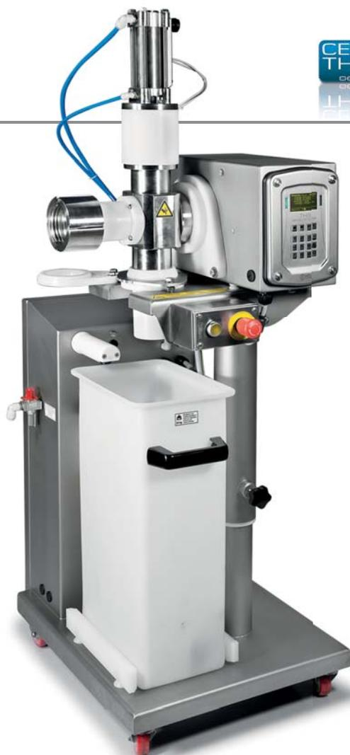
**Série THS/PLVM 21** : Système intégré avec vanne d'expulsion pour des applications à la sortie des machines ensacheuses.
