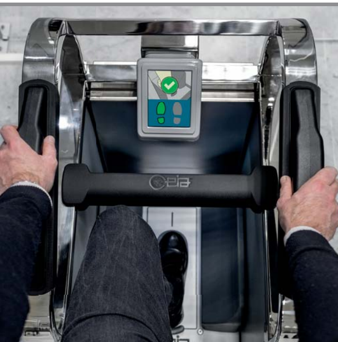
Poste d'inspection avec WTMD + SAMDEX et détecteur de traces d'explosif ETD
