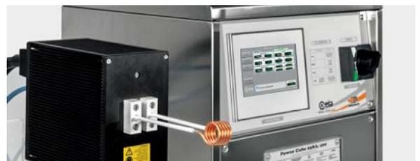
En cohérence avec les fonctions d'intégration et de contrôle des séries existantes, CEIA élargit la gamme de générateurs de chauffage à induction avec le générateur moyen-haute fréquence SA/400.
