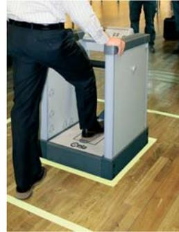
CEIA introduit l'analyseur de chaussures SAMD<sup>®</sup> développé pour éviter aux passagers de se déchausser dans les postes d'inspection filtrage.
