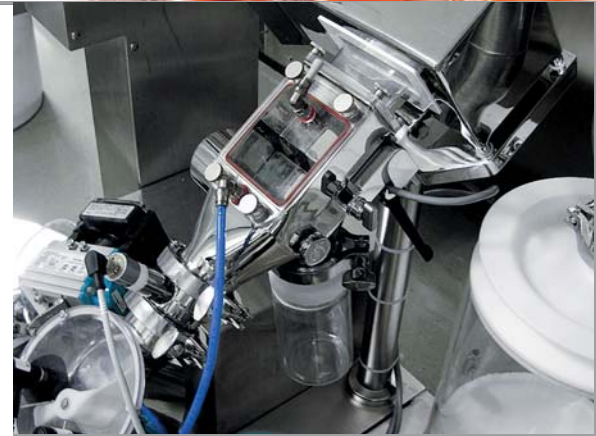
THS/PH21N-WIP: Wash-in-Place Metalldetektionssystem.
