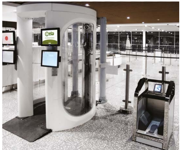
Ispezione dei passeggeri mediante sistema combinato [WTMD e SCANNER DI SICUREZZA] ed analizzatore di scarpe [SAMDEX]
