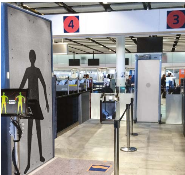
Ispezione dei passeggeri mediante sistema combinato [WTMD e SCANNER DI SICUREZZA] ed analizzatore di scarpe [SAMDEX]
